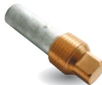
Réf: **VB020** Bougie laiton 200-250-270 L 40mm, Ø15mm, filetage 1/2" gaz conique
